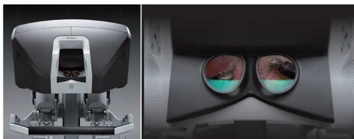
図1 3Dカメラシステム（サージョンコンソール）
